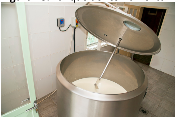
Figura 13: Tanque de resfriamento
