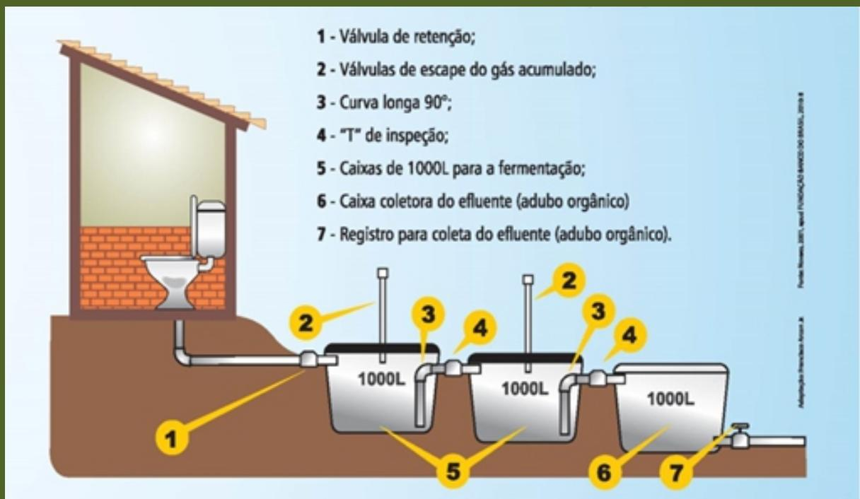
bactérias, as caixas devem ser enterradas no solo. Devido ao efeito da temperatura e da ação predatória de outros microrganismos, os coliformes são eficientemente eliminados ao longo do processo de tratamento, gerando um efluente com baixos valores de contaminação microbiológica.
